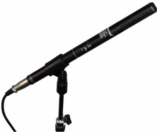
Fig. 2. Micrófono Hipercardioidie marca ASAJI modelo 1613.
